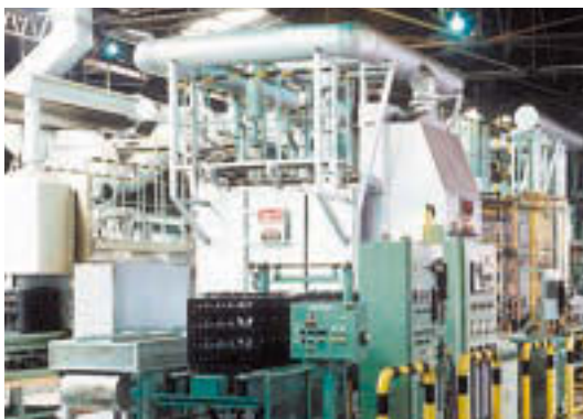
プッシャ型連続ガス浸炭炉
