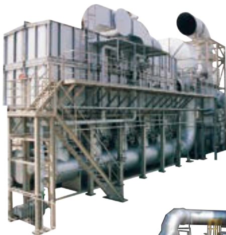
5塔式蓄熱排ガス処理装置 (RTO)
