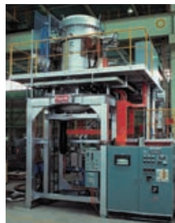
ガス圧高温炉
