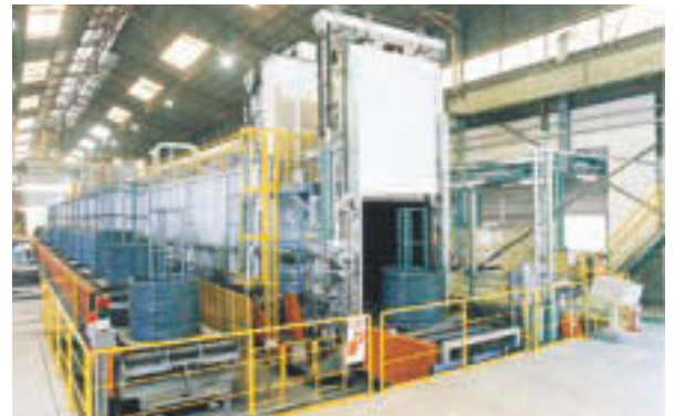
ローラハース型線材コイル連続焼なまし炉
