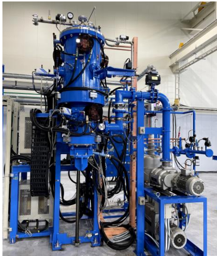
次世代電池素材熱処理炉
