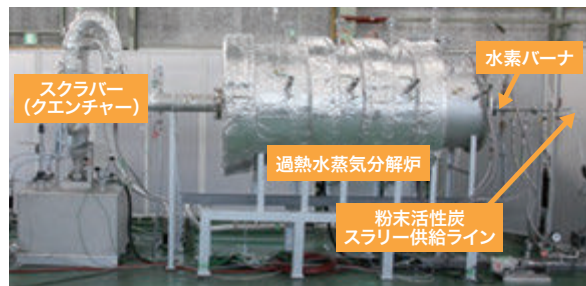
水素燃焼式高温過熱水蒸気分解処理試験装置
