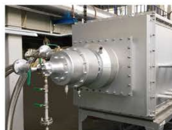
Ammonia Burner 氨燃烧器
