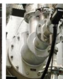
実証炉には水素専焼、 水素・都市ガス混焼、 都市ガス専焼に対応可能な 水素バーナを採用
