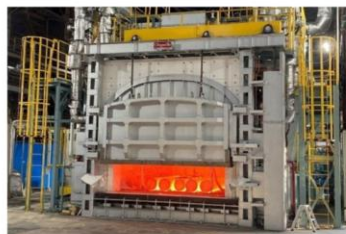
実証炉には水素専焼、 水素・都市ガス混焼、 都市ガス専焼に対応可能な 水素バーナを採用
